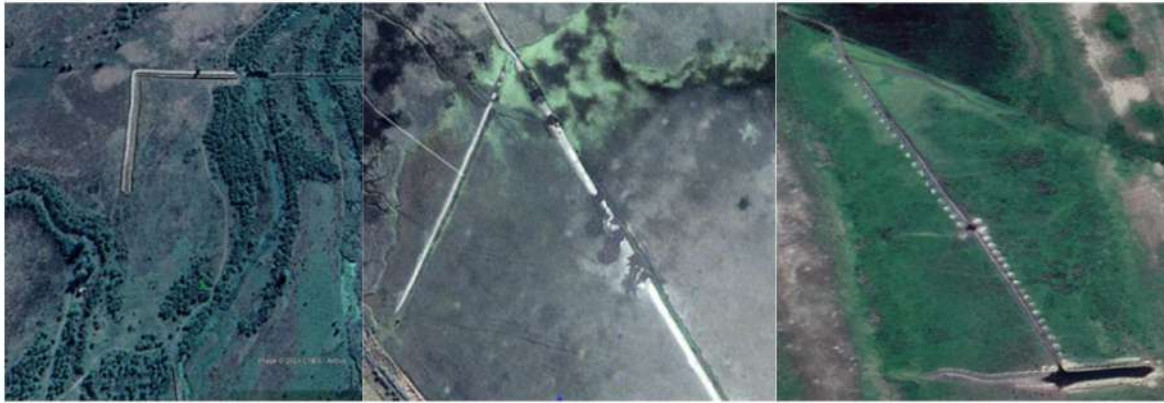
Figura 8. Ejemplos de terraplenes caracterizados de izquierda a derecha como "incipiente", "degradado" y "depósito de draga".
