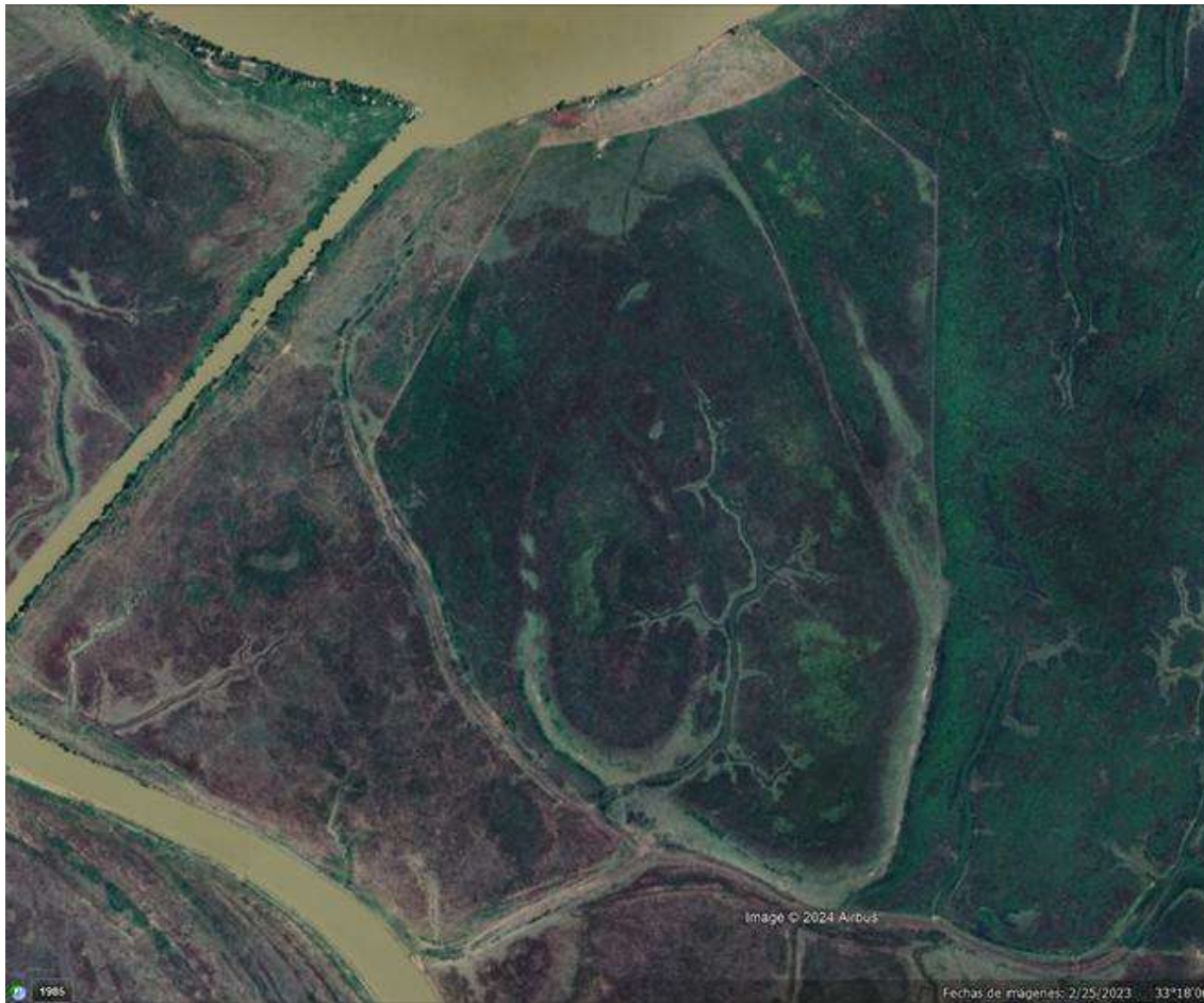
Figura 7. Ejemplo de dique caracterizado como "incipiente". Se observan claramente los terraplenes perimetrales pero no se pueden observar las áreas de extracción en todo el perímetro.
